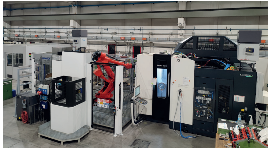
III Cella di lavoro costituita da un centro di lavoro a 5 assi e robot con 500 kg di portata.
