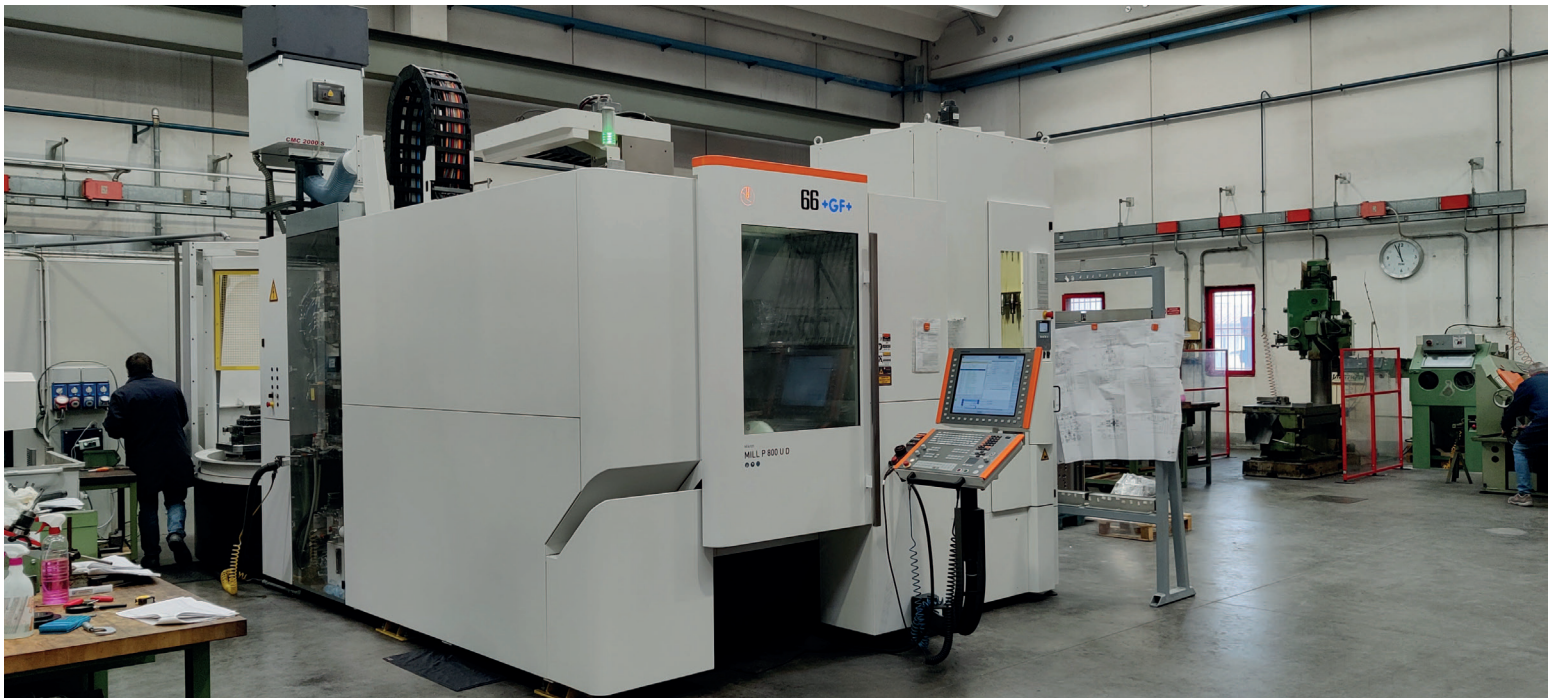
Il Centro di lavoro a 5 assi con magazzino da 160 utensili e 7 pallet.
